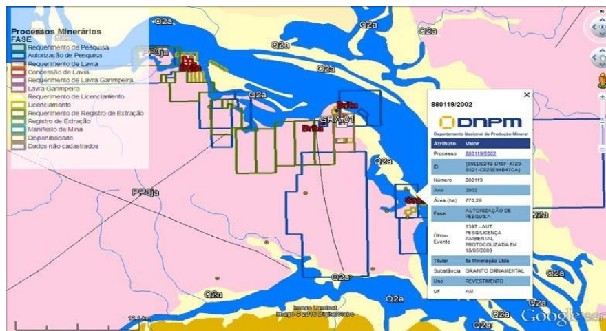
Figura 9 – Exemplo de informações geológicas e do Sigmime para rastrear locais de ocorrência de materiais (Fonte: DNIT)
